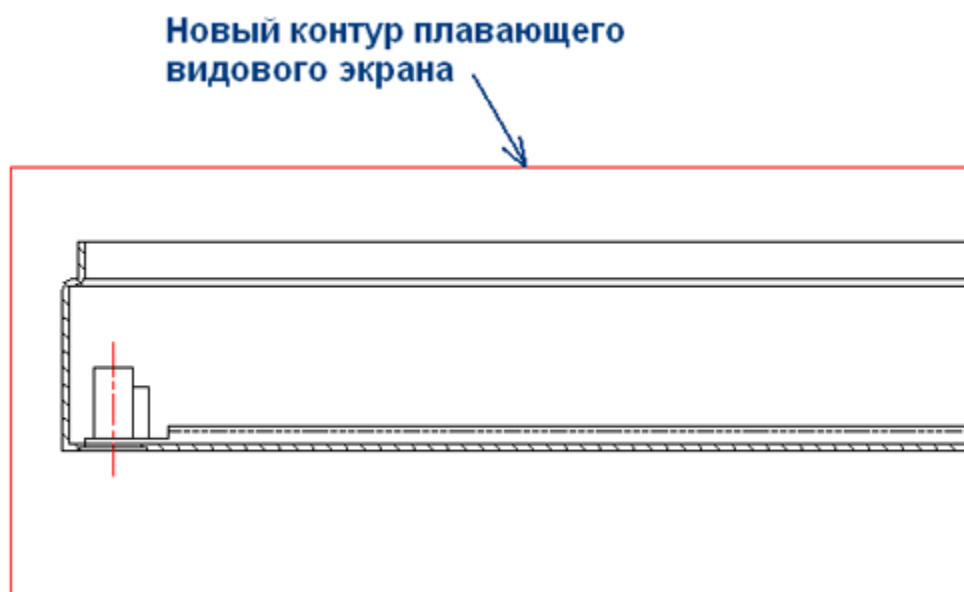
Результат изображения проекции после переноса угловых точек контура плавающего видового экрана
